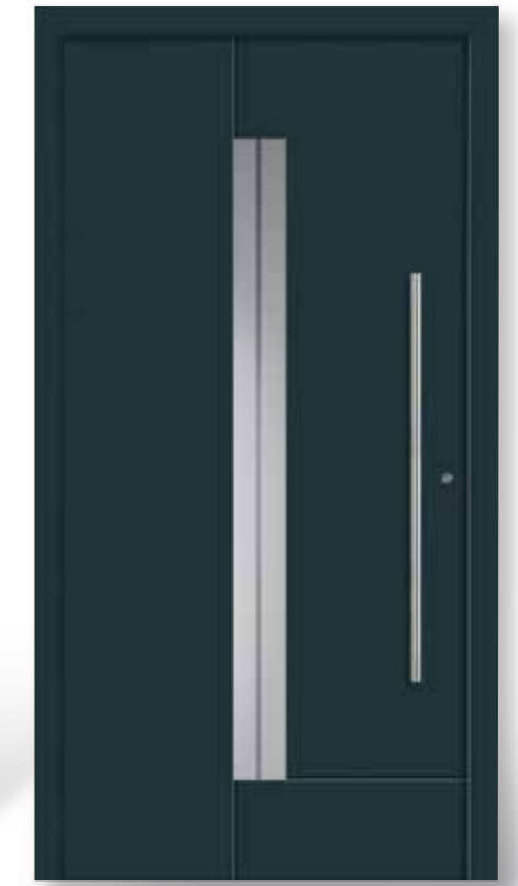
M-369 Ansicht A / DIN rechts Flachnuten außen ■ Aufsatzfüllung ■ Farbe Anthrazitgrau ähnl. RAL 7016 Feinstruktur ■ Sandstrahlmotiv Y1118 auf Klarglas | MG 2 ■ Griff ZAE 6, 1000 mm | PG 8
