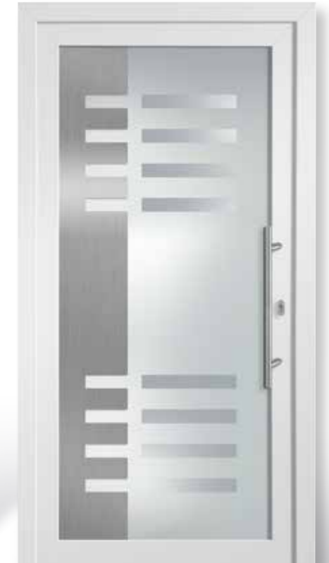
V-472 Ansicht A / DIN rechts Ganzglasfüllung 3-fach Glas Ug 1,7 bei 28 mm und Ug 1,1 bei 36 mm helle Flächen mattiert, dunkle Streifen Klarglas, kammartige Applikation in Edelstahloptik ■ Griff ZAE 6s, 600 mm | PG 6
