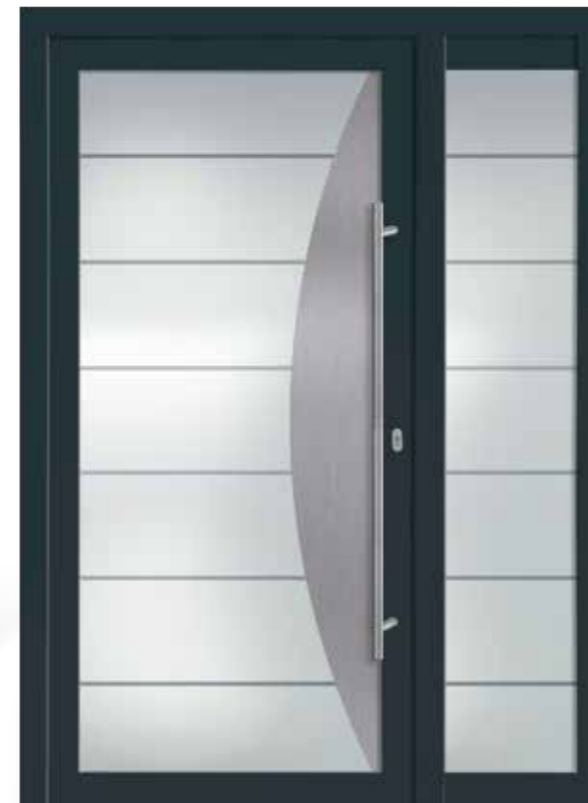
V-492 Ansicht A / DIN rechts Ganzglasfüllung 3-fach Glas Ug 1,7 bei 28 mm und Ug 1,1 bei 36 mm dunkle Streifen Klarglas, helle Flächen mattiert, bogenförmige Applikation in Edelstahloptik
