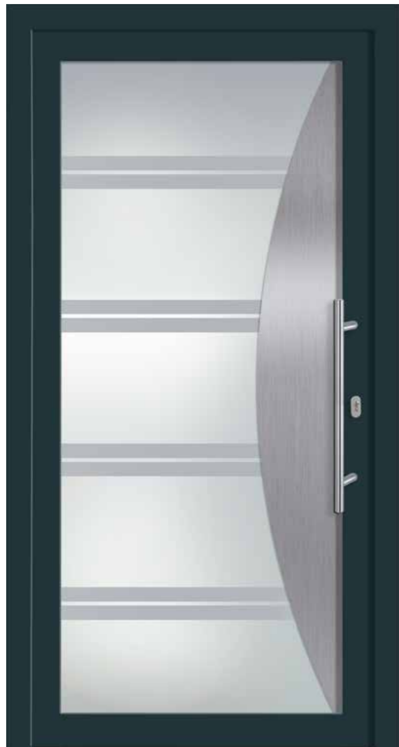
V-473 Ansicht A / DIN rechts Ganzglasfüllung 3-fach Glas, Ug 1,7 bei 28 mm und Ug 1,1 bei 36 mm bogenförmige Applikation in Edelstahloptik, helle Flächen mattiert, dunkle Streifen Klarglas
